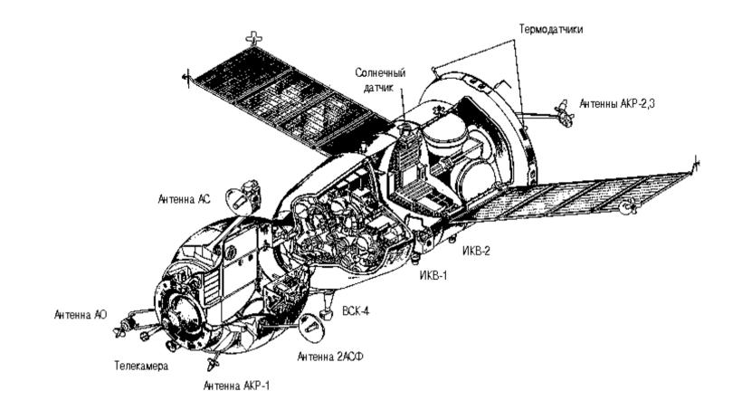
Рис. 2-2 : Внешний вид транспортного корабля "Союз ТМ"
