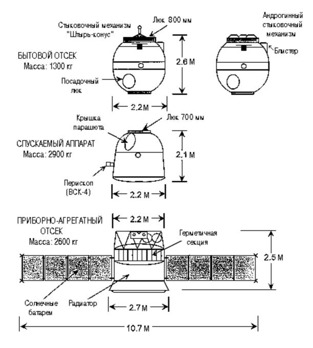
Рис. 2-1: Состав транспортного корабля "Союз ТМ"
