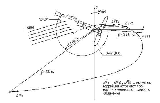
Рис.8-3: Автономный участок сближения после импульса AV 5
