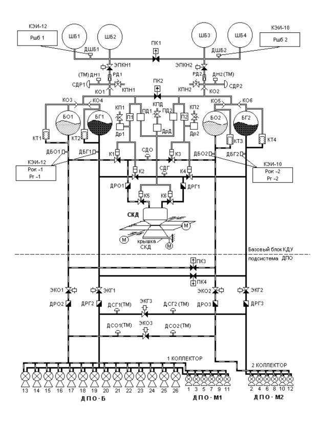
Fig. 2. КДУ Functional Block Diagram
