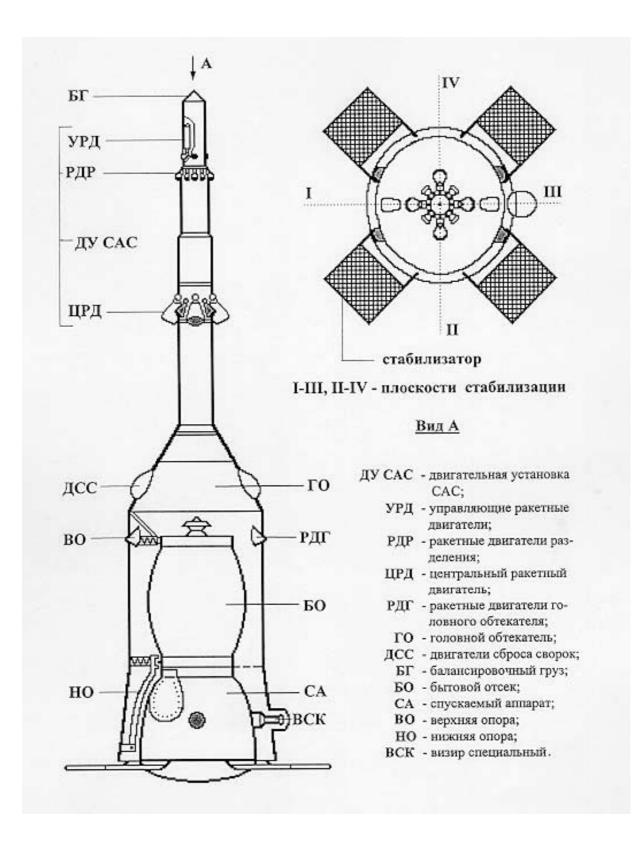
Fig. 1. CAC System Diagram.
