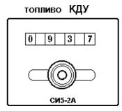
Fig. 12. Propellant Quantity Meter
