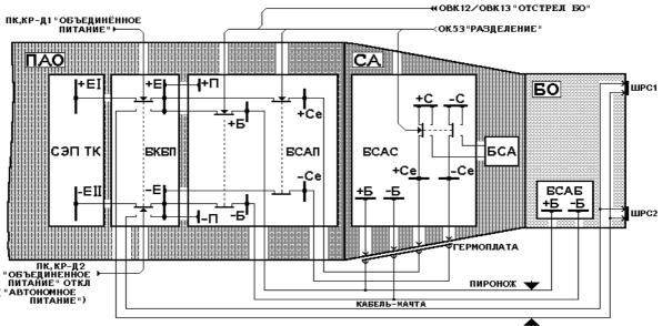
РИС. 2. РАСПРЕДЕЛЕНИЕ ШИН ЭЛЕКТРОПИТАНИЯ ОТСЕКОВ
