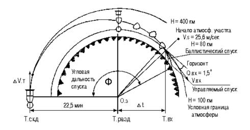
Рис.8-14: Штатная схема спуска
